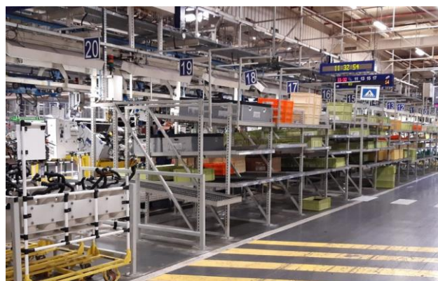
Installation de « rack » de pièces directement aux postes. Suppression de chariots filoguidés
